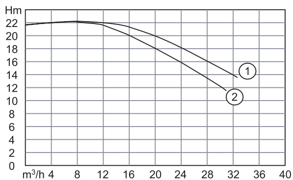
12. ábra - EWAP/EWYP 060-100 szivattyú jelleggörbe
