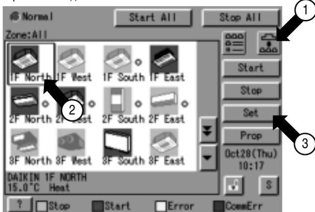
Сбросить обозначение фильтра или элемента после очистки кондиционера, показывающего знак фильтра или элемента.
