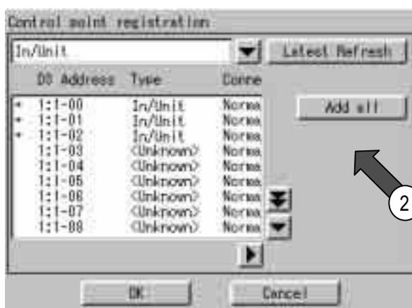
2. Добавить блоки управления кондиционерами следующим образом.
