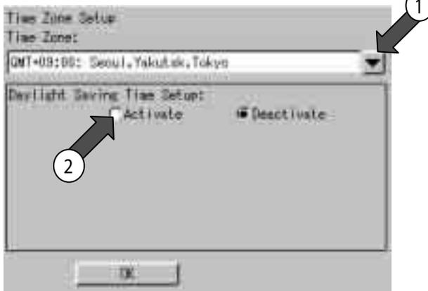
Задать часовой пояс в соответствии с местом использования микропроцессорного сенсорного контроллера (ИТС).
