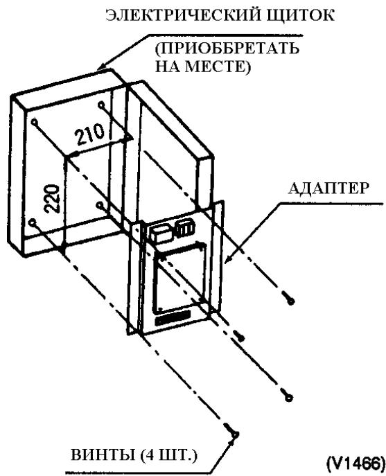
\* Электрический щиток должен иметь размеры 400 x 400 x 125 или более.
