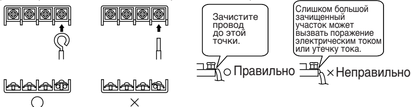
Зачистка провода на клеммной колодке
