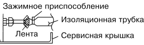
Для предотвращения попадания воздуха в пространство между медными трубами и изоляционной трубкой заизолируйте все соединения лентой или изоляционным материалом.
