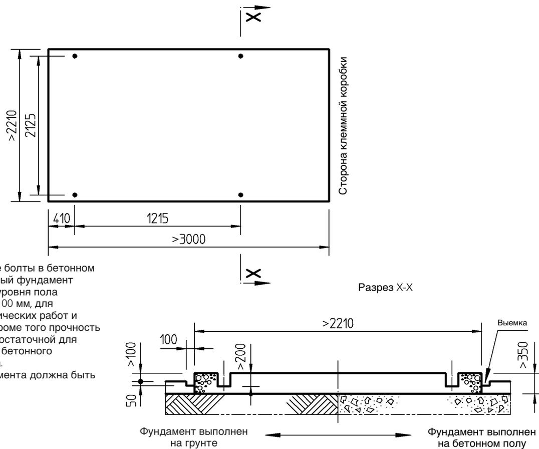
Закрепить анкерные болты в бетонном фундаменте. Бетонный фундамент должен быть выше уровня пола приблизительно на 100 мм, для облегчения сантехнических работ и лучшего дренажа. Кроме того прочность пола должна быть достаточной для выдерживания веса бетонного фундамента и блока. Поверхность фундамента должна быть ровной и плоской.
