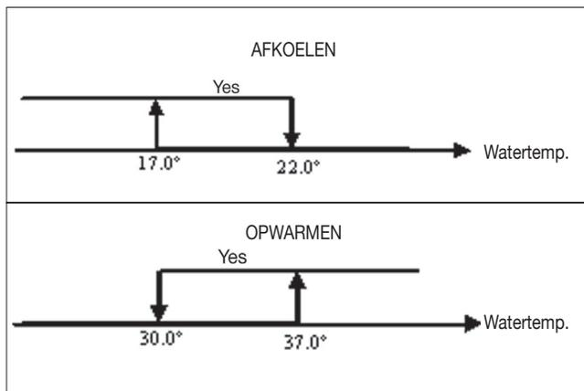
De afwezigheid van deze vrijgave op het moment dat de thermostaat hierom vraagt, wordt op het display aangegeven met het knipperen van het symbool voor de actieve modaliteit
