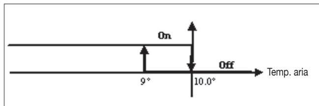
Una volta riportata la temperatura sopra i 10°C il termostato ritornerà nella situazione di OFF.
