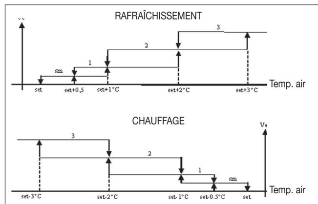
**NB:** pour les configurations à 4 vitesses et vanne ou 3 vitesses + CN, la ventilation dans le mode chauffage est remontée de 0,5°C pour permettre la convection naturelle dans la première phase.
