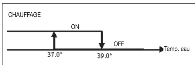
La commande d'activation de la résistance est liée au contrôle de la température de l'eau. Ci-dessous, la logique d'activation.
