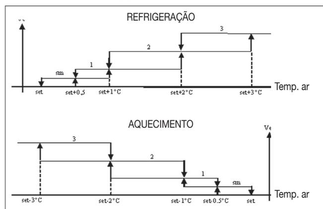
**NOTA:** nas configurações com 4 velocidades e válvula ou com 3 velocidades + CN, a ventilação no aquecimento é retardada de 0,5°C para permitir uma primeira fase de convecção natural
