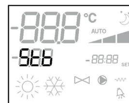
O monitor visualiza a velocidade de funcionamento (com eventual indicação da lógica “automática”) activa ou seleccionada (no caso de ventilador em stand-by)
