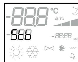
El display muestra la velocidad de funcionamiento (con eventual indicación de la lógica "automática") activada o seleccionada (en el caso de ventilador en stand-by).
