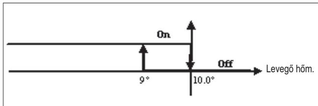
Miután a hőmérsékletet 10°C fölé emelik, a termosztát visszatér az Off helyzetbe.
