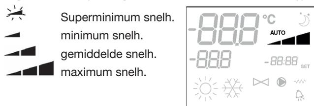
**NB:** in het geval dat de geactiveerde snelheid verschilt van de door de gebruiker gekozen snelheid (in het geval van een forcering), wordt met een enkele druk op de toets
