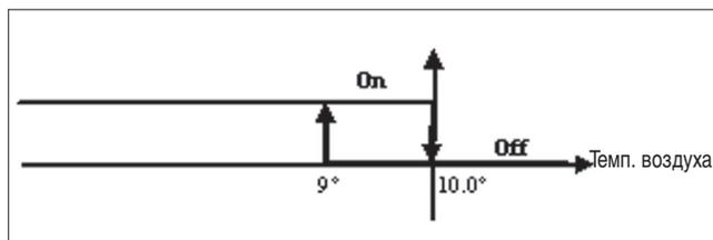
После того, как температура поднимется выше 10°C термостат вернётся в состояние Off.
