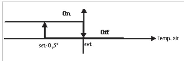
La résistance électrique sélectionnée par l'utilisateur est activée par le thermostat en fonction de la température ambiante
