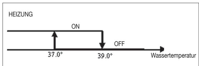
Die Einschaltfreigabe des Widerstands ist an die Kontrolle der Wassertemperatur gebunden. Nachstehend wird die entsprechende Freigabelogik gezeigt: Diese Freigabe wird nicht gegeben, wenn keine Wassersonde vorgesehen oder wenn sie nicht angeschlossen ist.
