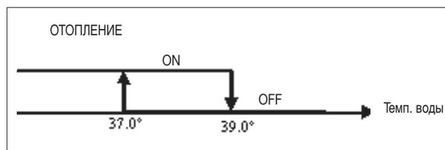
Отпирющий сигнал для включения электрического нагревателя связан с контролем температуры воды. Соответственно отрегулирована логика его функционирования.
