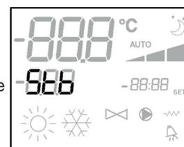
Il display visualizza la velocità di funzionamento (con eventuale indicazione della logica "automatica") attiva o selezionata (nel caso di ventilatore in stand-by)
