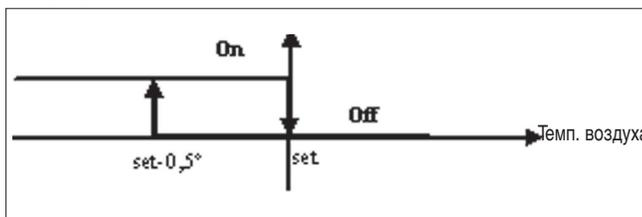
Применение электрического нагревателя, если он был выбран пользователем, происходит при вызове со стороны термостата, в зависимости от температуры в помещении.
