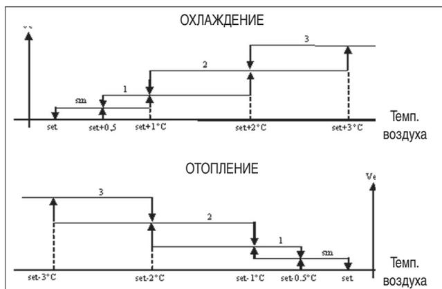
**примечание:** в конфигурации с 4 - мя скоростями и клапаном или 3 - мя скоростями + E , вентиляция при отоплении задерживается на 0.5°C, чтобы на начальном этапе работать в режиме естественной конвекции.
