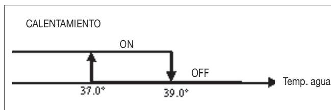
El consentimiento para la activación de la resistencia está relacionado con el control de la temperatura del agua. Se indica a continuación la respectiva lógica de consentimiento. Este consentimiento no será dado en caso de que la sonda del agua no esté prevista o esté desconectada.
