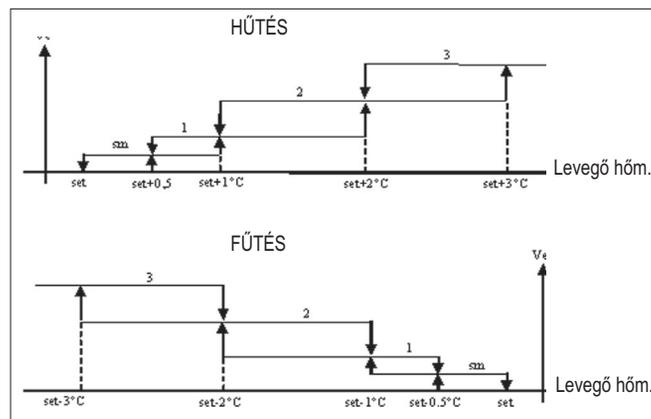
**MEGJ.:** a 4 sebesség és szelepes vagy a 3 sebesség + CN-es konfigurációknál a fűtés melletti ventiláció 0.5°C -kal késleltetve van azért, hogy lehetővé tegye a természetes hőáramlás első fázisát.
