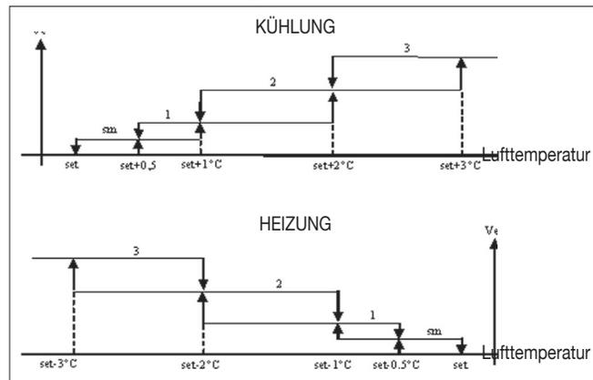
**Anm.:** Bei Konfigurationen mit 4 Geschwindigkeiten und Ventil oder 3 Geschwindigkeiten + CN wird die Lüftung im Heizbetrieb um 0,5°C verzögert, um eine erste Phase der natürlichen Konvektion zu ermöglichen.
