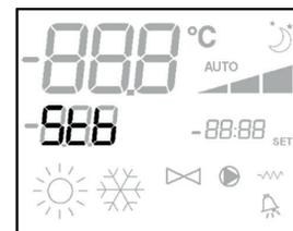
Am Display werden angezeigt die momentane oder (bei Ventilator in Standby) die gewählte Betriebsgeschwindigkeit (mit eventueller Anzeige der "automatischen" Logik)
