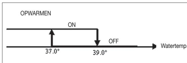
De vrijgaven van water voor de activering van de weerstand is gebonden aan de controle van de watertemperatuur. Hierop volgt de desbetreffende logica voor de vrijgave. Deze vrijgave wordt niet gegeven in het geval dat van een niet voorziene of losgekoppelde meter.
