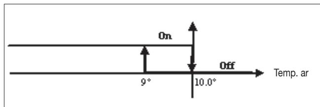
Quando a temperatura voltar acima de 10°C o termostato retorna à situação Off.
