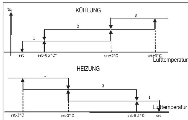
Bei Konfigurationen mit 4 Geschwindigkeiten:
