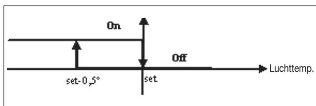
Het gebruik van de elektrische weerstand, als deze door de gebruiker geselecteerd wordt, vindt op aanvraag van de thermostaat naar aanleiding van de omgevingstemperatuur plaats.
