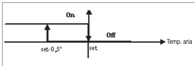
L'utilizzo della resistenza elettrica, se selezionata da utente, viene utilizzata su chiamata del termostato in base alla temperatura ambiente
