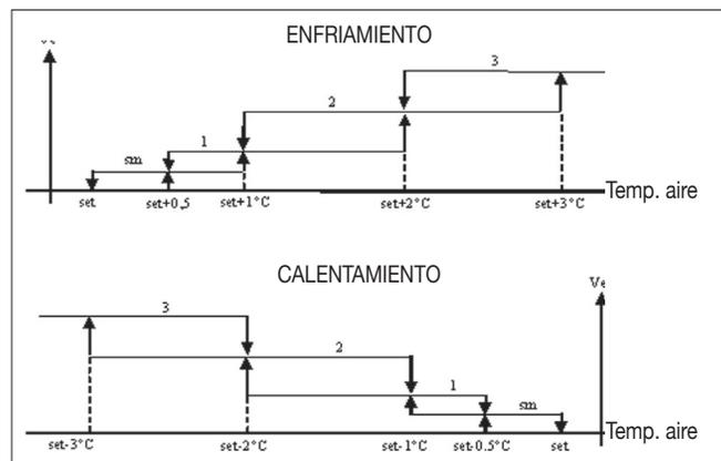
**NOTA:** En las configuraciones con cuatro velocidades y válvula o con tres velocidades + CN, la ventilación en calefacción es retardada en 0,5 °C para permitir la ejecución de una primera fase de convección natural.
