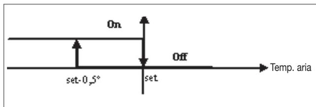
A resistência eléctrica, se seleccionada pelo utilizador, é usada sob solicitação do termostato, com base na temperatura ambiente
