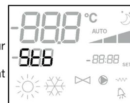
Le moniteur affiche la vitesse de fonctionnement (avec indication éventuelle de la logique "automatique") active ou sélectionnée (dans le cas de ventilateur en stand-by)
