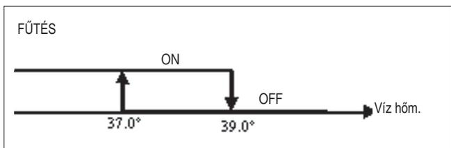
A fűtőelem aktiválásának engedélyezése a víz hőmérsékletének ellenőrzéséhez kötődik. A következőkben a relatív engedélyezési logika
