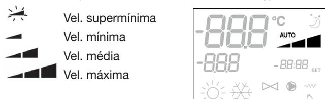
**NOTA:** se a velocidade activa for diferente daquela seleccionada pelo utilizador (em caso de forçamento), a primeira pressão da tecla
