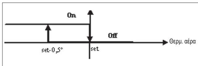
Η χρήση της ηλεκτρικής αντίστασης, εάν επιλεγθεί από το χρήστη, χρησιμοποιείται με κλήση του θερμοστάτη ανάλογα με τη θερμοκρασία περιβάλλοντος.
