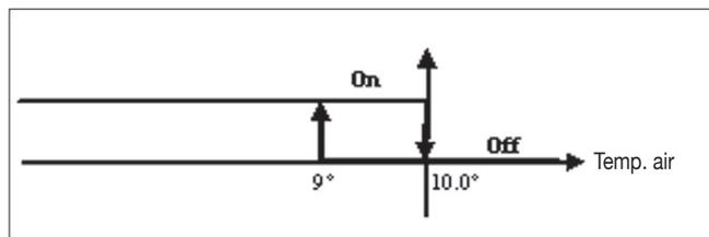
Lorsque la valeur de la température remonte à plus de 10°C le thermostat revient à la situation de Off.
