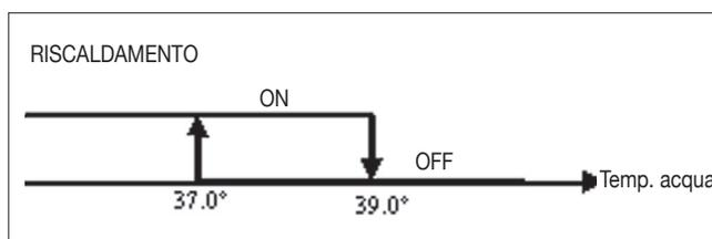
Il consenso per l'attivazione della resistenza è legato al controllo della temperatura dell'acqua. Di seguito la logica di consenso relativa
