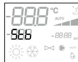
A display megjeleníti az aktív vagy kiválasztott működés sebességét (az "automatikus" logika esetleges megelőlésével) (stand-by állapotban lévő ventilátor esetén).
