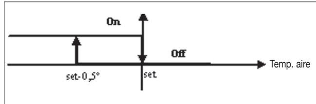
La utilización de la resistencia eléctrica, en caso de ser seleccionada por el usuario, depende de la llamada del termostato en función de la temperatura ambiente.
