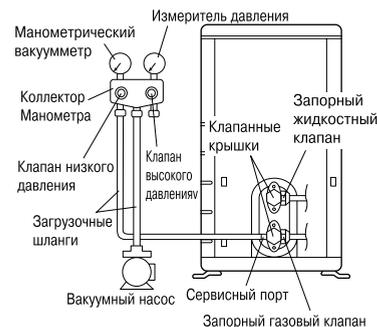
1) Присоедините утолщение загрузочного шланга (подводимого от коллектора манометра) к сервисному порту газового запорного клапана.
