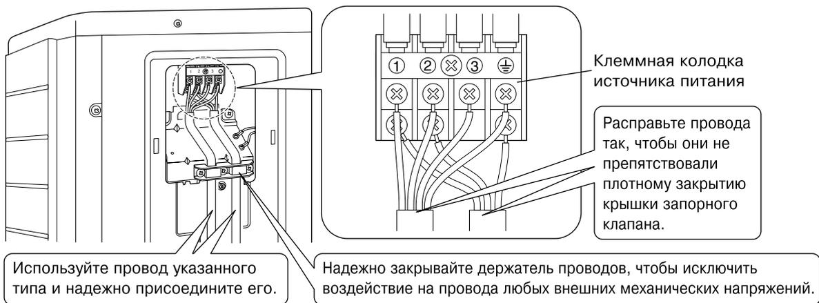
При подключении проводов к концевой колодке источника питания обращайте внимание на приведенные ниже замечания. Необходимые меры предосторожности в отношении проводки источника питания. При подключении к концевой колодке источника питания используется округлый штырь для обжимного соединения.
