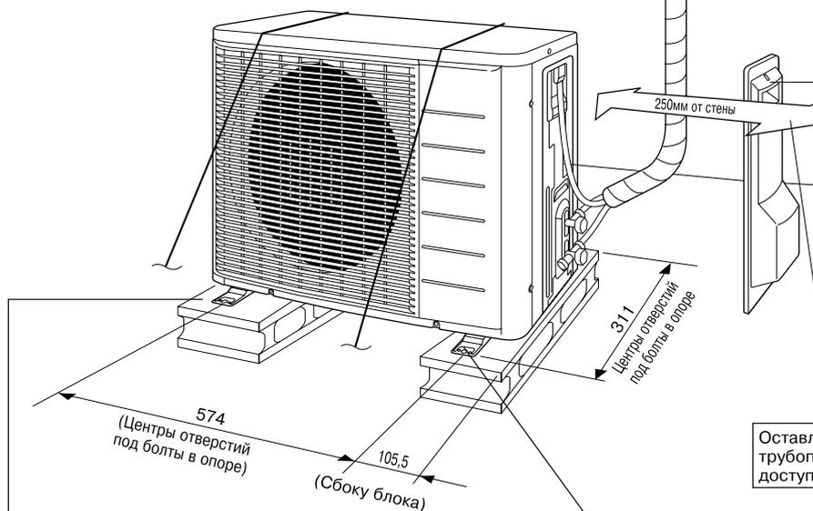
Оставляйте место для трубопровода и для сервисного доступа к электрическим цепям.
