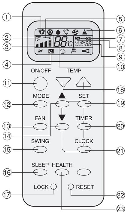
1. Индикация режимов работы: автоматический режим (AUTO) ☼; режим охлаждения (COOL) ❄️; режим осушения (DRY) 💧; режим нагрева (HEAT) 🔥; режим вентиляции (FAN) 🌀.
