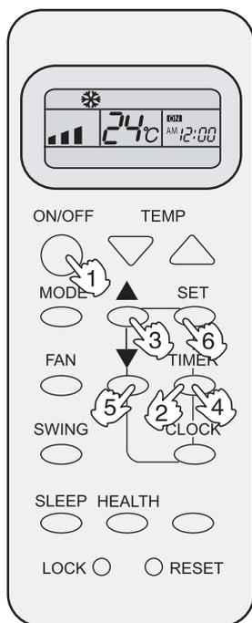
1. После включения кондиционера с помощью пульта ДУ выберите необходимый режим работы кондиционера. При этом текущий режим работы кондиционера отобразится на индикации пульта, а на панели внутреннего блока загорится индикатор OPERATE (зеленый).
