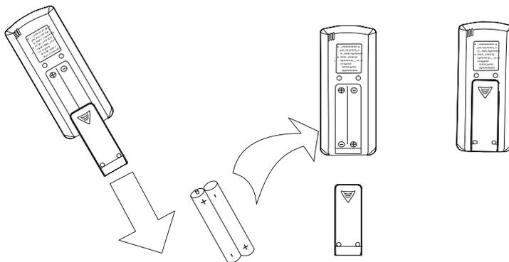
Если после включения блока путем нажатия кнопки ON/OFF на экране пульта ничего не отображается, перезаправьте батарейки.
