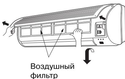
3. Для чистки фильтра используйте пылесос или промойте фильтр под водой, после чего просушите его в тени.
