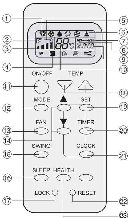
1. Индикация режимов работы: автоматический режим (AUTO) ☼; режим охлаждения (COOL) ❄️; режим осушения (DRY) 💧; режим нагрева (HEAT) 🔥; режим вентиляции (FAN) 🌀.
