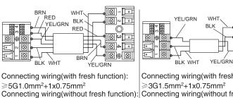
$\geq$ 5G1.0mm<sup>2</sup> Power cable:  $\geq$ 3G1.5mm<sup>2</sup>
