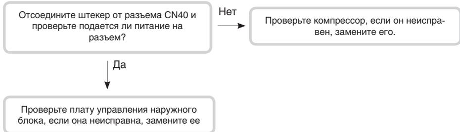
**Примечание.** Выключите сетевой выключатель перед подсоединением или разъединением штекеров, в противном случае могут быть повреждены детали электрической схемы.
