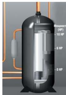
Компрессор переменной производительности. Мощность изменяется ступенчато
