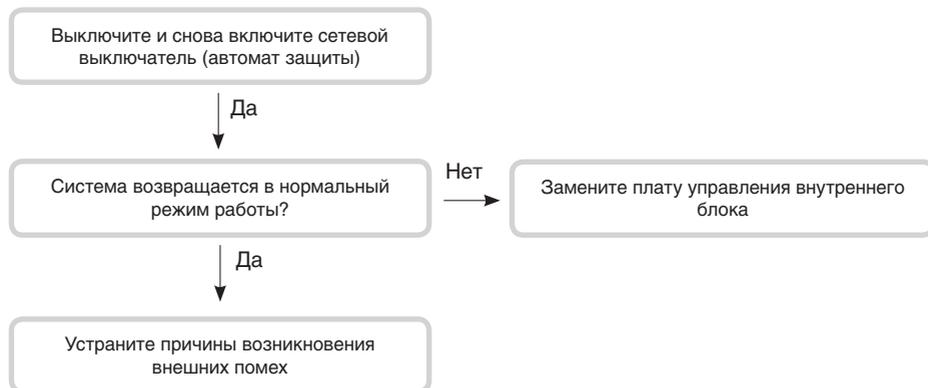
**Примечание.** Выключите сетевой выключатель перед подсоединением или разъединением штекеров, в противном случае могут быть повреждены детали электрической схемы.
