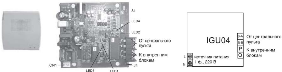
**Соединение проводов с платой адаптера iGU04**
