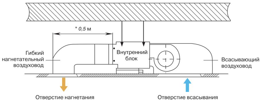
\*Часть воздуховода должна быть установлена в месте подключения.
