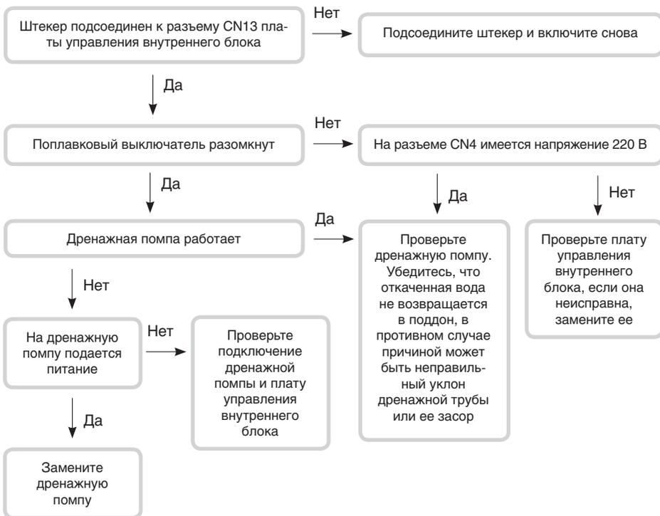
**Примечание.** Выключите сетевой выключатель перед подсоединением или разъединением штекеров, в противном случае могут быть повреждены детали электрической схемы.
