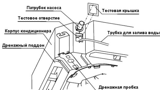
2) Включите электропитание блока и запустите его в режиме охлаждения. Прислушайтесь к звукам, издаваемым насосом. Проверьте, удаляется ли конденсат по шлангу (после включения кондиционера может пройти около минуты до начала вытекания конденсата, в зависимости от длины шланга). Убедитесь, что вода не вытекает через места соединения труб.
