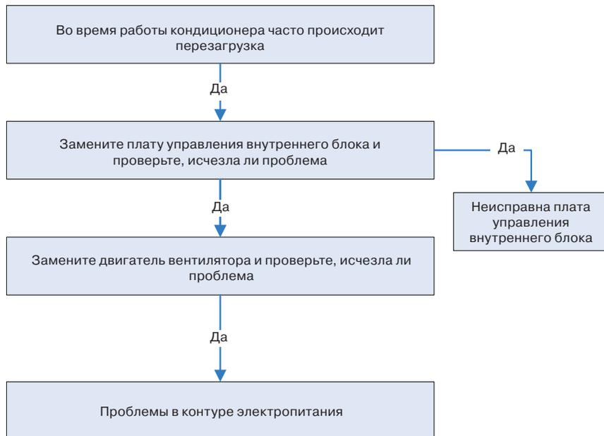
**Индикатор работы мигает, лампа таймера выключена**
