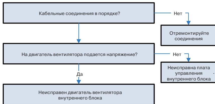
**Индикатор работы мигает, лампа таймера включена**
