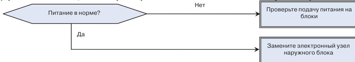
**P2 (Срабатывание защиты от перегрева компрессора).**
