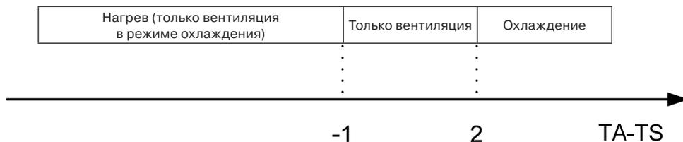
Вентилятор внутреннего блока включается в соответствии с выбранным режимом.
