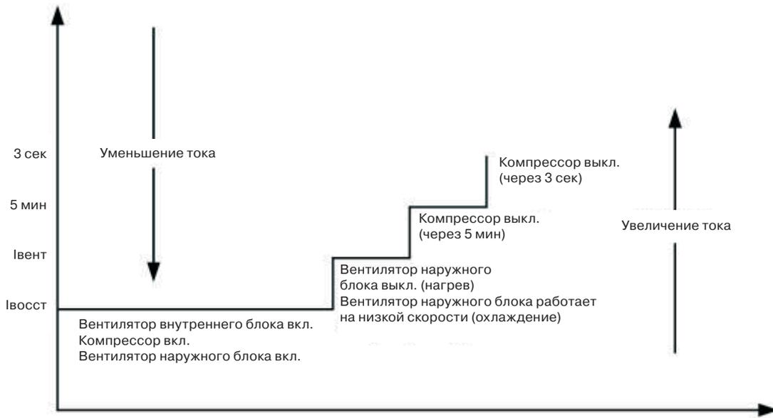
Если компрессор в течение 5 минут выключается 4 раза, устройство выключается, на дисплее появляется сообщение об ошибке и устройство не может возобновить работу автоматически.
