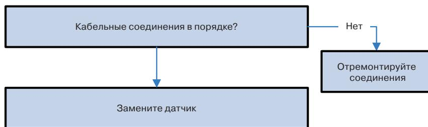
**Индикатор работы выключен, лампа таймера мигает**
