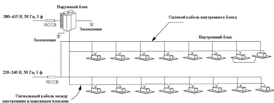
Сигнальный провод должен соединять соответствующие терминалы. Ошибочное соединение приведет к неисправной работе.
