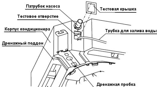
2) Включите электропитание блока и запустите его в режиме охлаждения. Прислушайтесь к звукам, издаваемым насосом. Проверьте, удаляется ли конденсат по шлангу (после включения кондиционера может пройти около минуты до начала вытекания конденсата, в зависимости от длины шланга). Убедитесь, что вода не вытекает через места соединения труб.
