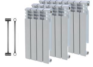
Секционные биметаллические радиаторы FURST изготавливаются путем заливки цельносварной стальной сердцевины под давлением высококачественным сплавом алюминия с кремнием.
