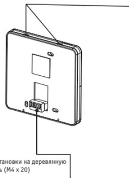
При установке крышки проводного пульта управления убедитесь в наличии ниши в стене, чтобы не крепить заднюю крышку пульта управления непосредственно к стене, поскольку в противном случае креплению задней стенки будет мешать соединительный разъем.
