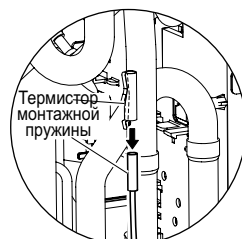
Термистор вытяжной трубы (R3T)
