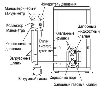
1) Присоедините утолщение загрузочного шланга (подводимого от коллектора манометра) к сервисному порту газового запорного клапана.
