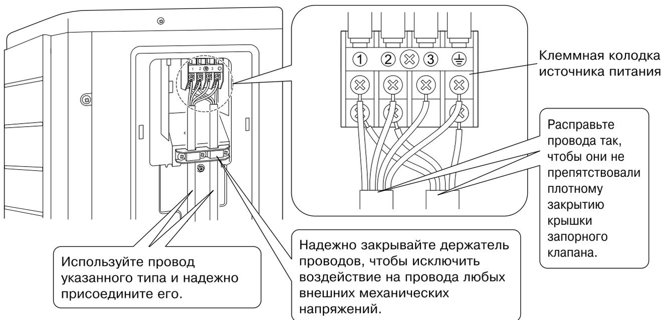
При подключении проводов к концевой колодке источника питания обращайте внимание на приведенные ниже замечания.
