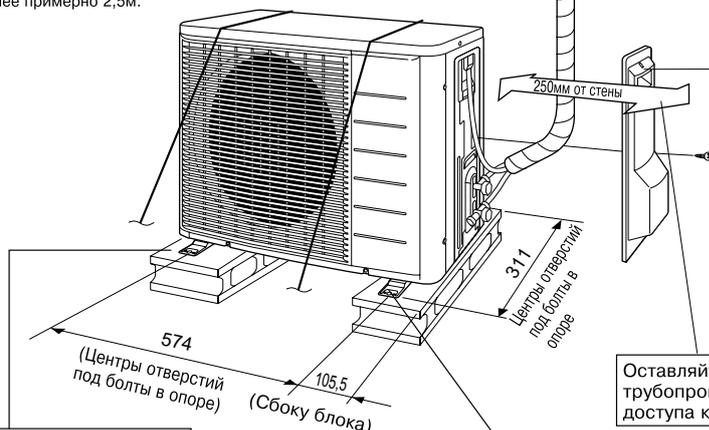
В местах с плохим дренажом используйте для наружных блоков блочные основания. Регулируйте высоту подставки вплоть до полного выравнивания блока по горизонтали. В противном случае может произойти утечка или выливание воды.
