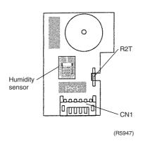
PCB(5): Streamer Unit PCB
