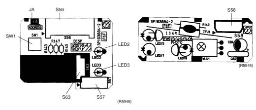
PCB(4): Humidity sensor PCB
