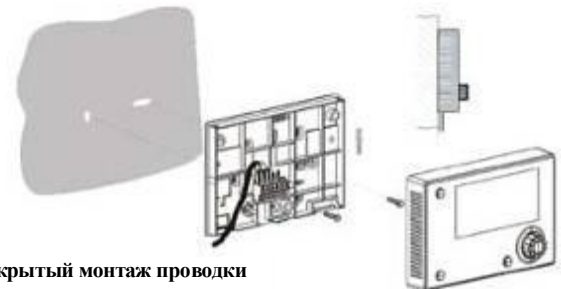
Прокладка проводки через стену
